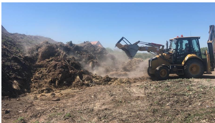
Obrázok 18 – Bager pri prevzdušňovaní odpadu
