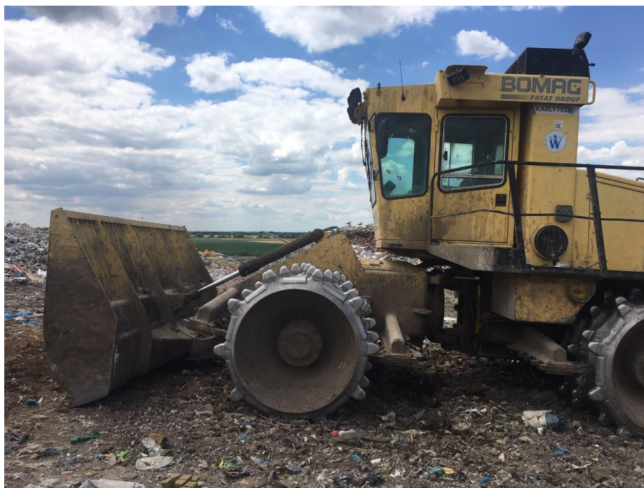
Obrázok 30 – Kompaktor na zhutnenie odpadov na telesa skládky
