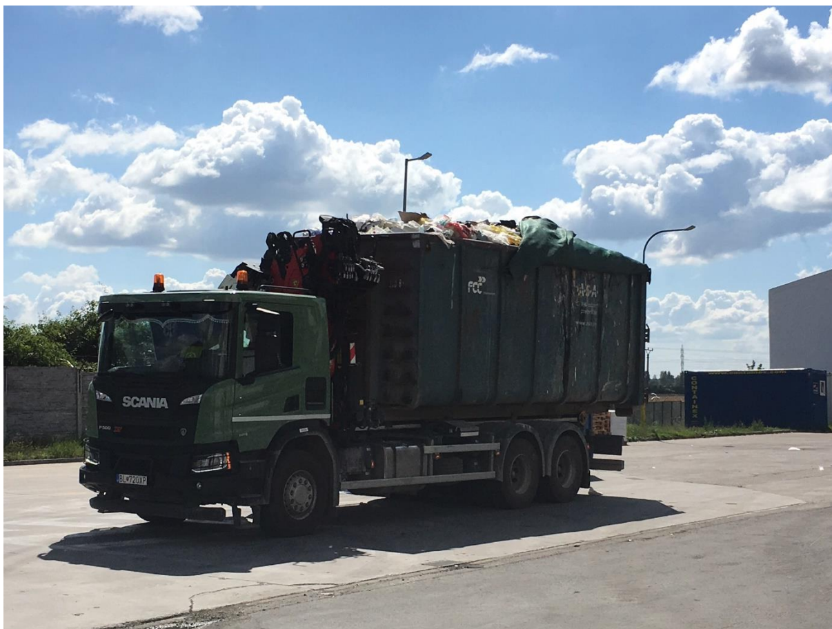
Obr. č. 33 Vytriedený objemový odpad je odvážaný kontajnerovými autami s hydraulickou rukou, Vozidlo pred vykládkou v spoločnosti ecorec Slovensko s.r.o.
