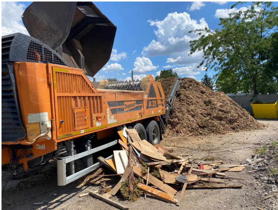
Obr. č.15 – Štiepkovanie biologicky rozložiteľného odpadu –odpadového dreva.
