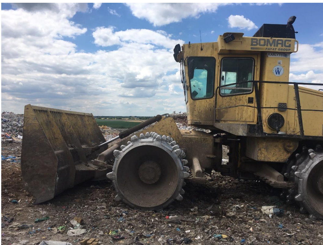
Obr. č.22 - Kompaktor na zhutnenie odpadu na skládke
